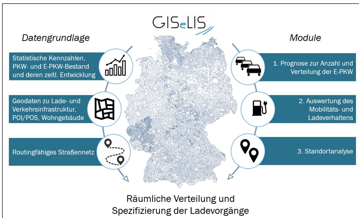
Abbildung 5 Funktionsweise des Standortmodelles für Ladeinfrastruktur GISeLIS
