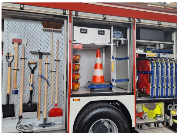
Abbildung 9 Vegetationsbrandbekämpfungsseite des TLF mit Handwerkzeug (links) und D-Schlauch-Tragekörben (rechts)
