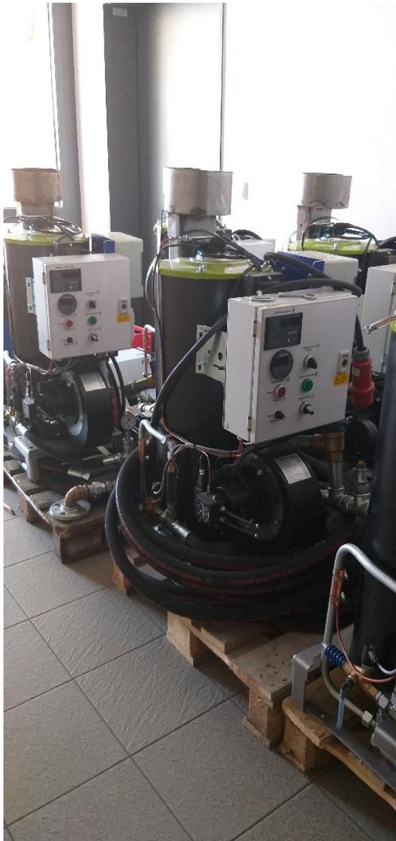
Abbildung 22 Durchlauferhitzer mit Pumpe, Steuereinrichtung und Schlauchmaterial
