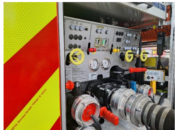
Abbildung 8 Pumpe mit A-125-Saugeingang (hier mit Reduzier-Stück auf 110 mm für die Systemüberprüfung)
